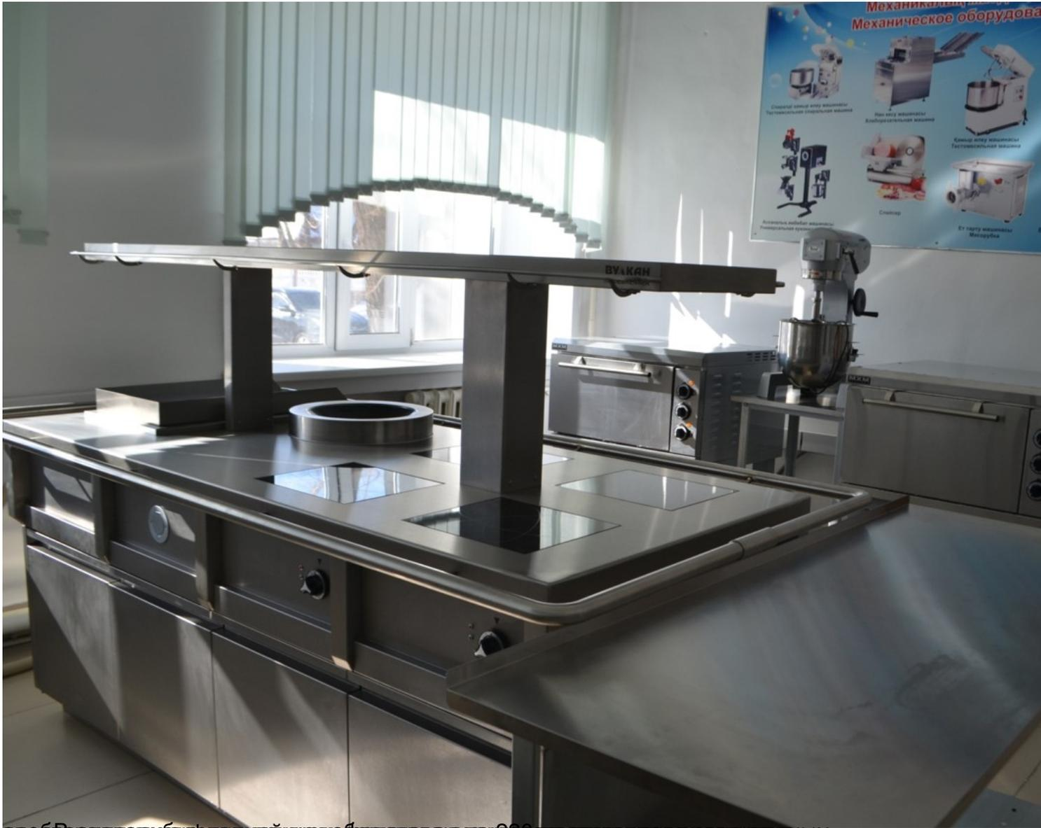
Экспонат № 26. Выдвижной стол с индукционной плитой и вытяжкой
